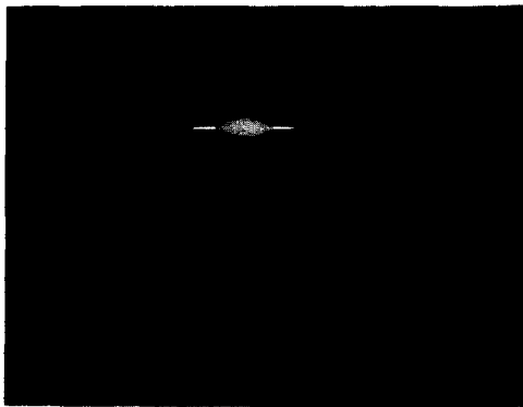
그림 13. 제작된 위상변조기의 도파로로부터 출사되는 단일모드의 near field pattern.(입사광의 파장= 1.31 µm)
