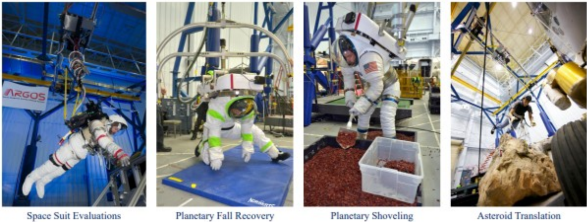
[그림 8] NASA 존슨우주센터에 설치된 미세중력 모사 장치 ARGOS를 활용한 우주비행사 훈련 모습 (출처: NASA)
