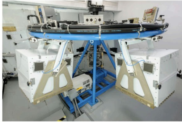
[그림 10] 미생물, 식물, 소동물에 적용 가능한 1.22 미터 반경의 고중력 모사 장치(출처: NASA)
