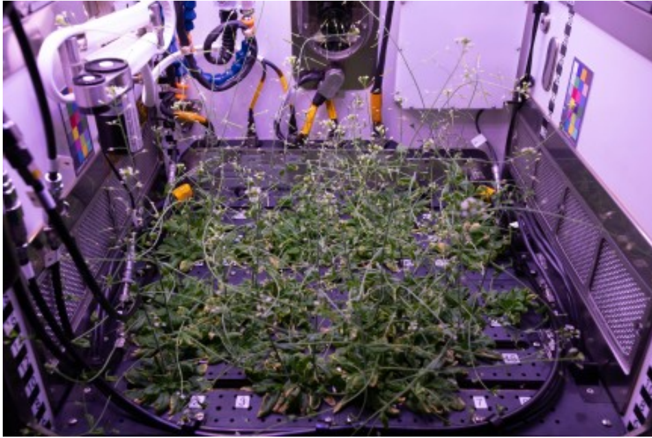
[그림 4] ISS에서 식물 모델을 이용한 연구에 사용되는 식물배양 장비 Plant Habitat (출처: NASA)
