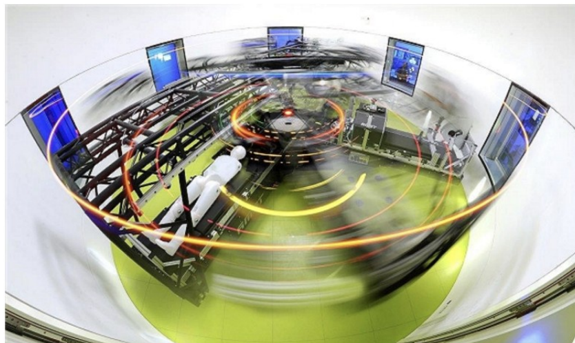
[그림 9] 인체용 중력 부하 장치(출처: 독일 DLR)
